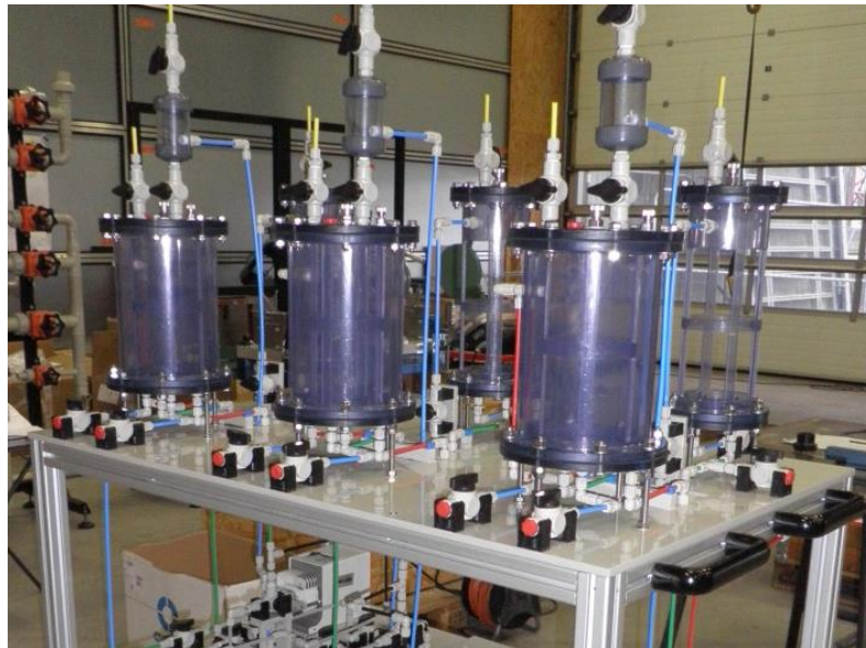
Abbildung 2: Laborreaktoren zur Beurteilung der Elektrodengeometrien
